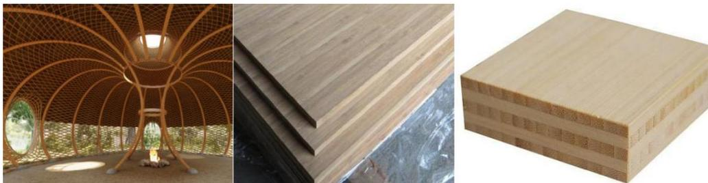
图 3.5.1-1 圆竹材（左）、胶合竹板（中）、重组竹板（右）
