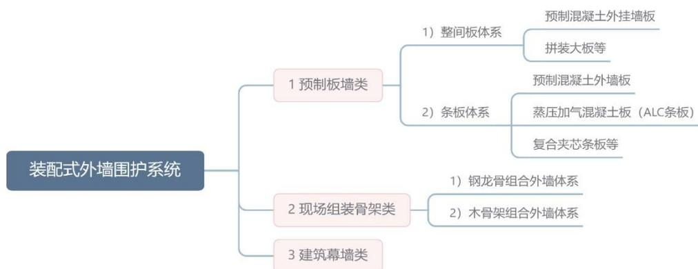
图 3.2.1-1 装配式外墙围护系统分类
