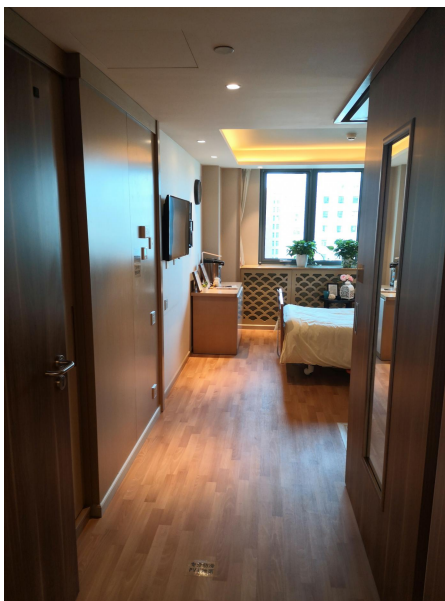
图 3.3.4-3 卧室照明灯具布置方式 (图 2 射灯会对老人产生眩光)
